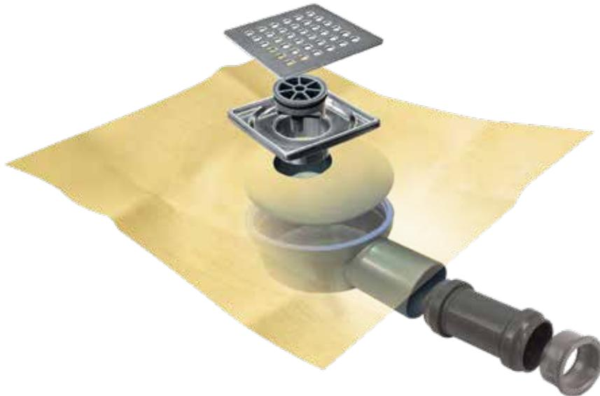
Kit de sumidero sifónico (convertible en no sifónico) para ducha de obra que incorpora salida HORIZONTAL de 50 mm y reducción a 40 mm, con lámina impermeable **DRY40** tipo EVAC de 25 x 25 m termosellada a la tapa. Incluye lámina **DRY40** suelta de 1,5 x 2 m (3m<sup>2</sup>).
