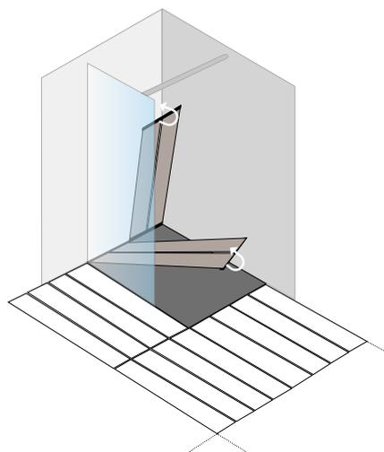
C\_PIEZA CERÁMICA ÚNICA\_Disposición HORIZONTAL del pavimento
