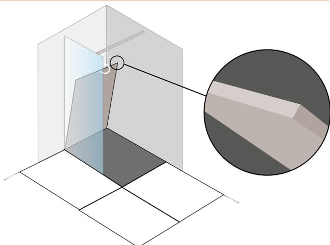
D\_PIEZA CERÁMICA ÚNICA\_Disposición VERTICAL del pavimento
