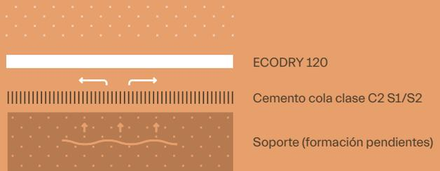
IMPERMEABILIZACIÓN CON LÁMINA ECODRY120
