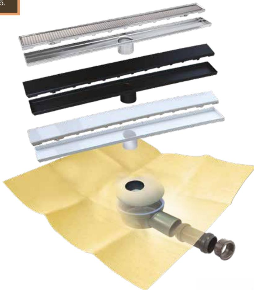
Kit de sumidero sifónico (convertible en no sifónico) para ducha de obra que incorpora salida HORIZONTAL de 50 mm y reducción a 40 mm, con lámina impermeable DRY50 tipo EVAC de 1,5 x 2 m termosellada a la tapa.
