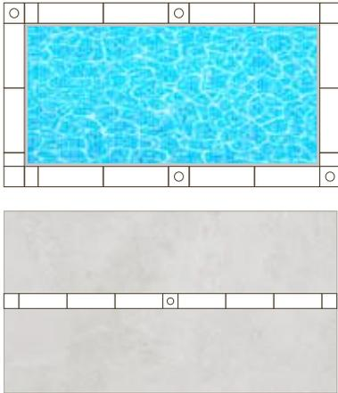
Conseguir plano acotado de la cubierta/piscina y enviar a **REVESTECH** junto a las medidas del modelo del pavimento elegido. La distancia máxima entre sumideros recomendada es de 4 m. Consultar con el departamento técnico de **REVESTECH**.
