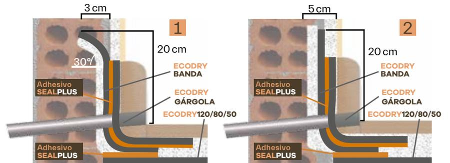
Insertar el tubo dentro de la salida horizontal del muro, haciendo un agujero en la banda **ECODRY BANDA**.
