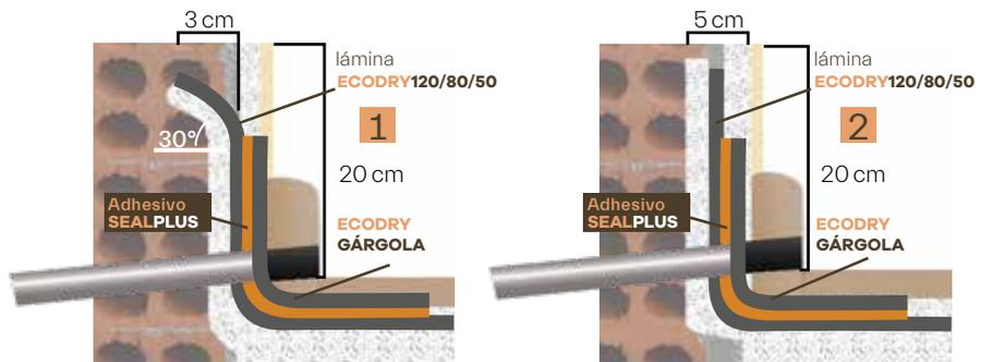
Insertar el tubo dentro de la salida horizontal del muro, haciendo un agujero en la lámina **ECODRY120/80/50**.
