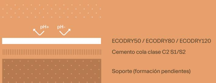
IMPERMEABILIZACIÓN CON LÁMINAS ECODRY50 / ECODRY80 / ECODRY120
