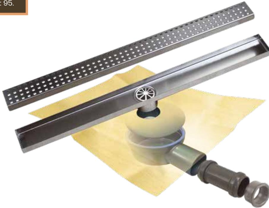
Kit de sumidero sifónico (convertible en no sifónico) para ducha de obra que incorpora salida HORIZONTAL de 50 mm y reducción a 40 mm, con lámina impermeable **DRY40** tipo EVAC de 25 x 25 m termosellada a la tapa. Incluye lámina **DRY40** suelta de 1,5 x 2 m (3m<sup>2</sup>).
