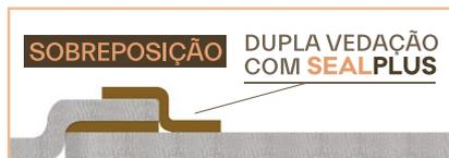
As lâminas são instaladas com **10 cm de sobreposição** duplamente coladas com adesivo especial Sealplus.
