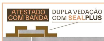
As lâminas são instaladas lado a lado, com uma **banda impermeável sobreposta de 13 cm de largura**, duplamente coladas com adesivo especial Sealplus.
