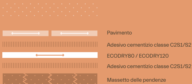
STRATIGRAFIA IMPERMEABILE CON LAMINA ECODRY80 O ECODRY120
