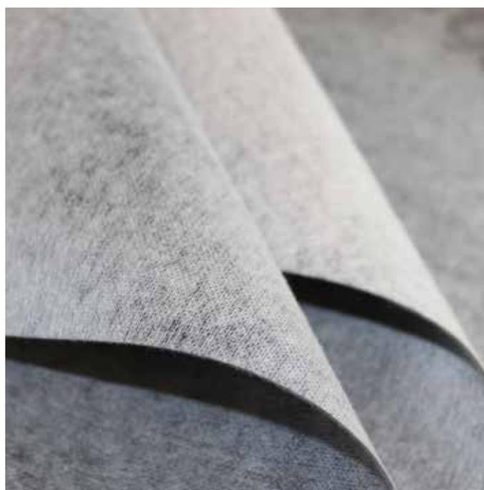
**ECODRY50** e **ECODRY80** extrudados em fibras de poliéster e **ECODRY120** em fibras de poliéster e polipropileno; todas permitem uma ótima colagem com o cimento-cola C2 S1/S2, utilizado para a sua instalação como lâminas totalmente coladas e protegidas. Permitem união e selagem com o nosso adesivo **SEALPLUS** ou com soldadura por ar quente, como é o caso do **ECODRY80**.
