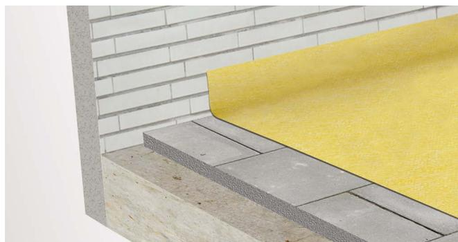
a) mediante un retranqueo cuya profundidad con respecto a la superficie externa del paramento vertical debe ser mínimo de 5 cm y cuya altura por encima de la protección de la cubierta debe ser mínimo de 20 cm.
