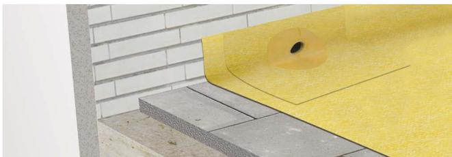
Insertar el tubo dentro de la salida horizontal del muro, haciendo un agujero en la lámina **DRY120**.
