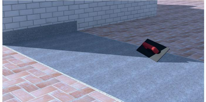
**2.** Presionar fuerte la lámina sobre el soporte con ayuda de la llana, asegurándose de eliminar todas las posibles bolsas de aire que se hayan generado. ATENCIÓN: una vez instalada, se deberá comprobar que la lámina esté totalmente pegada al soporte.
