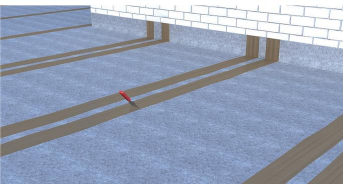
**5.** Realizar un doble sellado sobre los bordes de la banda con adhesivo **SEALPLUS**. **OPCIONAL:** Una vez finalizada la instalación, con un tiempo de espera de 48 horas, se puede realizar una prueba de estanqueidad precisa.
