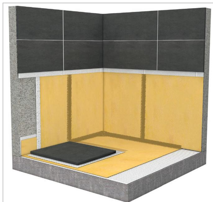
3. Extender una capa fina de cemento cola C2 S1/S2 con la llana de 4 mm y revestir la pared con la lámina **DRY50** dejando un solape entre láminas de al menos 5 cm. Comprobar que la lámina esté bien extendida y sacar el aire que se pueda haber generado con ayuda de la llana. Sellar las uniones con **SEALPLUS** realizando un doble sellado (ver punto 2.).
