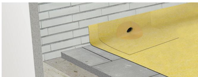
Insertar el tubo dentro de la salida horizontal del muro, haciendo un agujero en la lámina **DRY120**.
